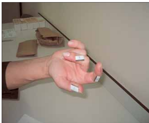
Рис. 2. Размещение сборок детекторов ТЛД-500К ( \alpha\text{-Al}_2\text{O}_3\text{:C} ) в специальных пакетах на пальцах оператора перед проведением измерений
